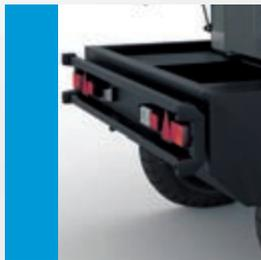
❷ La unidad se suministra de serie en un tren de rodaje de tipo rueda de carro. Dependiendo de las necesidades del cliente, también existen otras opciones: "tren de rodaje de tipo rueda de carro con freno para remolque rápido", que permite remolcar la unidad en vías públicas y chasis "sin ruedas" (soporte fijo).
