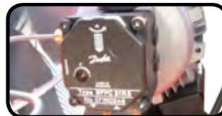
Bomba de inyección de gasóleo a alta presión, diseñadas para trabajar 24 horas al día. Es capaz de aspirar gasóleo de un depósito nodriza a 15 metros de distancia.
