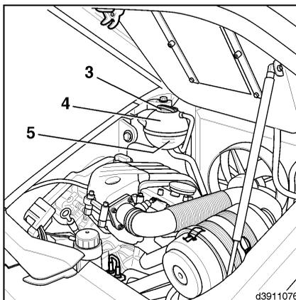
La protección anticongelación es eficaz para temperaturas que lleguen hasta -25 °C. La proporción de mezcla necesaria es de un 40% de aditivo refrigerante y un 60% de agua potable.
