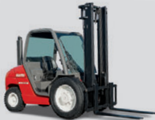
MSI 30 G con depósito fijo (versión estándar con bombona de gas)
