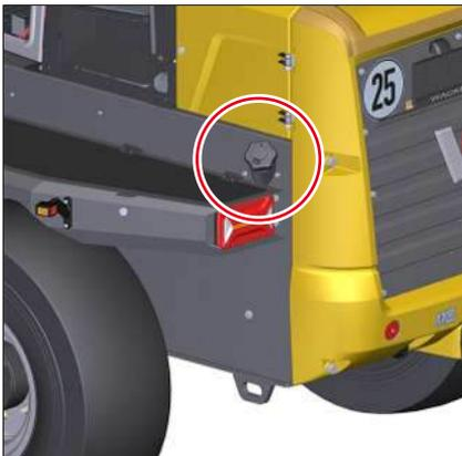
Fig. 202: Abertura de llenado para el combustible
