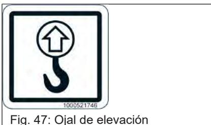
Fig. 47: Ojal de elevación
