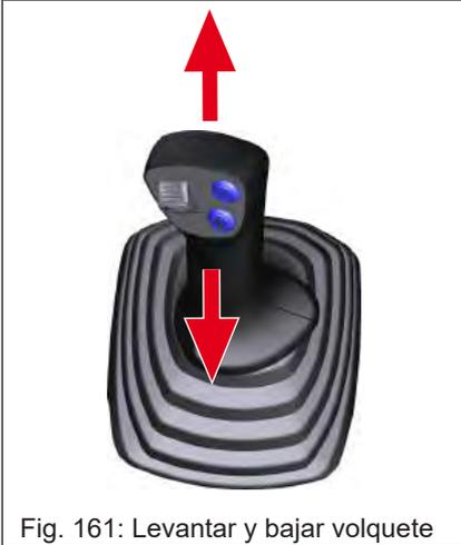
Fig. 161: Levantar y bajar volquete
