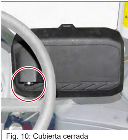
Antes de poner en funcionamiento el motor, abrir y encajar la cubierta de la pantalla. Dejar abierta la cubierta de la pantalla mientras el vehículo está en funcionamiento.
