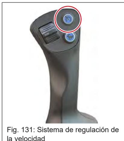
Fig. 131: Sistema de regulación de la velocidad
