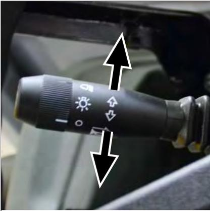
Fig. 145: Palanca multifunción
