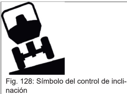
El control de inclinación envía una advertencia óptica y acústica si el vehículo está demasiado inclinado y se acciona el volquete.
