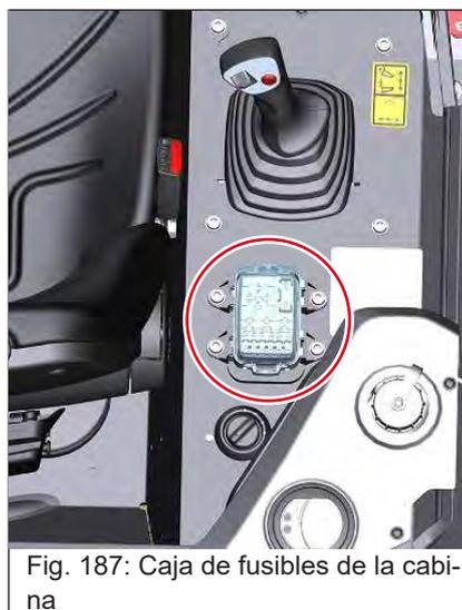
Fig. 187: Caja de fusibles de la cabina
