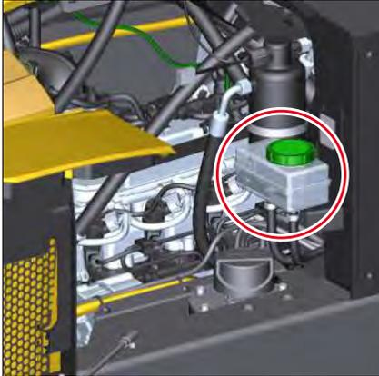
Fig. 213: Posición del depósito del líquido de frenos
