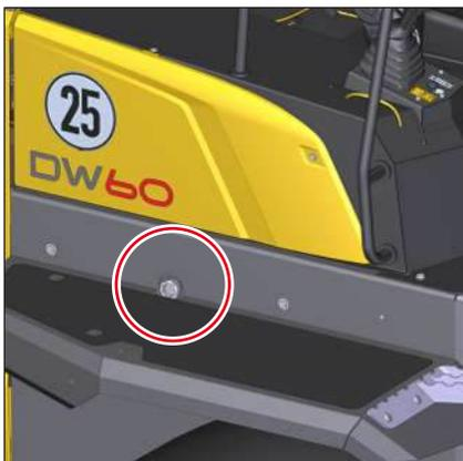
Fig. 200: Controlar el nivel de aceite hidráulico
