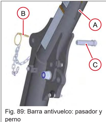
Fig. 89: Barra antivuelco: pasador y perno
