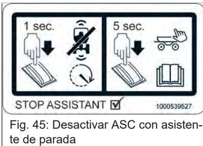
Fig. 45: Desactivar ASC con asistente de parada
