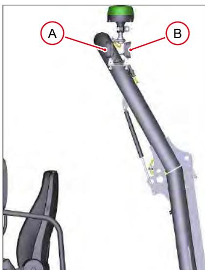
Fig. 140: Luz de trabajo de la barra antivuelco
