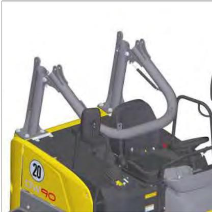
Fig. 90: Barra antivuelco plegada hacia abajo
