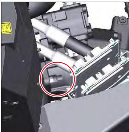
Fig. 169: Válvula derecha limitadora de presión
