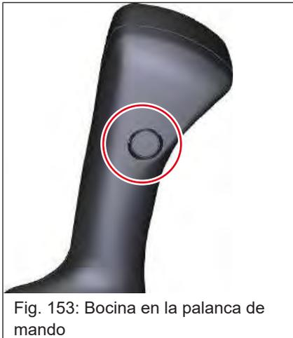
Presionar el botón de la parte trasera de la palanca de mando.
