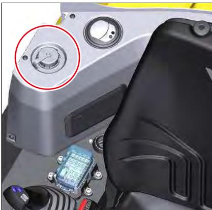
Fig. 215: Depósito de agua limpiaparabrisas
