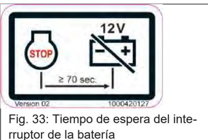
Fig. 33: Tiempo de espera del interruptor de la batería
