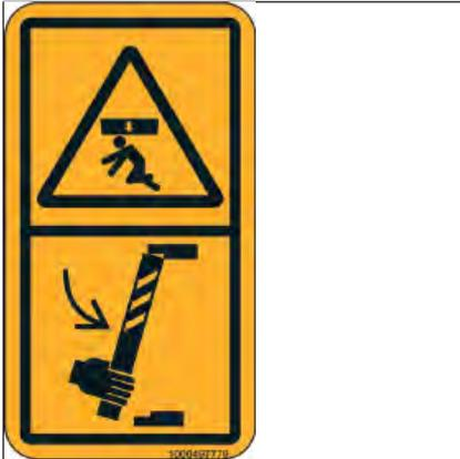
Fig. 25: Apoyo de mantenimiento/bloqueo articulado
