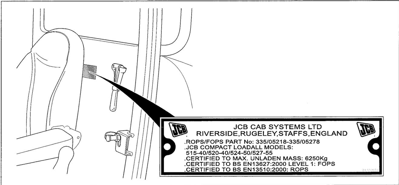
Las máquinas construidas conforme a las normas ROPS/FOPS llevan una chapa de identificación en el interior de la cabina.
