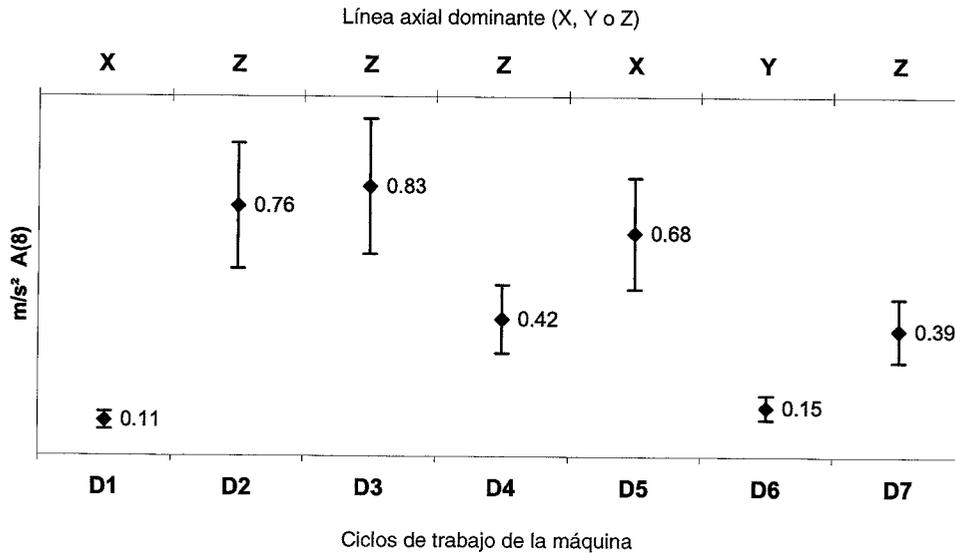
La emisión de vibración en todo el cuerpo, determinada de conformidad con ISO 2631-1:1997 para este tipo de máquina, es de 0,42 m/s<sup>2</sup> normalizada a un período de referencia de 8 horas [A(8)] y basada en un ciclo de pruebas que comprende "Recogida y Colocación" y "Trabajo con la Cargadora (Tierra)".
