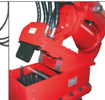
Sistema Huppi-Quick (conexiones hidráulicas se conectan automáticamente)
