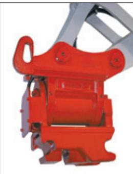
Power tilt con enganche rápido hidráulico
