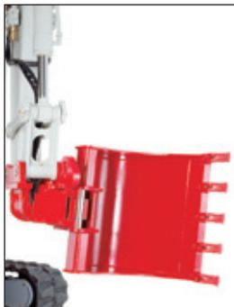
Power tilt con enganche rápido hidráulico y cazo montado al revés
