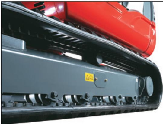
Rodillo con doble guía para un óptimo y seguro funcionamiento de las cadenas de goma Double-Short- Pitch para evitar la vibración
