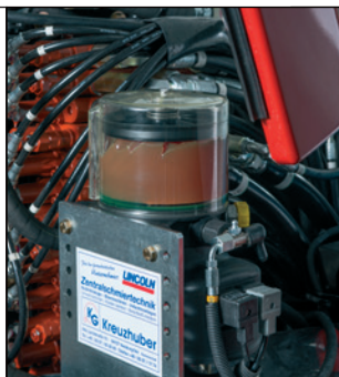
Engrase centralizado con cantidades medidas con control de nivel
