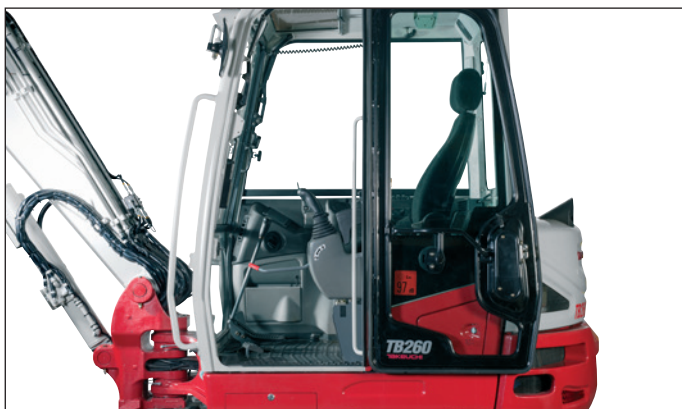
Amplia cabina insonorizada, pobre en vibraciones, compartimentos para guardar cosas, entrada ancha con fijación de puerta, cristal frontal abatible, aire acondicionado.
