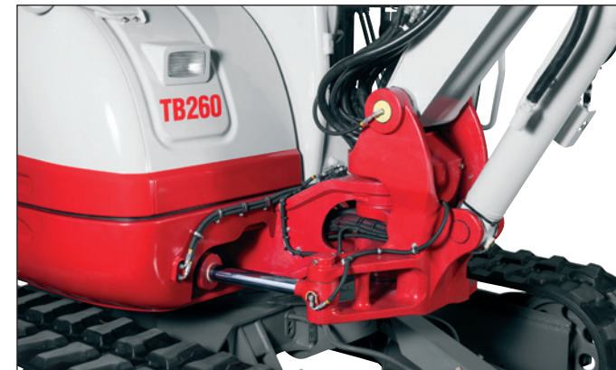
Bloque de giro robusto con cilindro de giro del brazo. Cilindro de elevación con amortiguación en el final de carrera. Aviso de sobrecarga y válvula antiretorno de serie.
