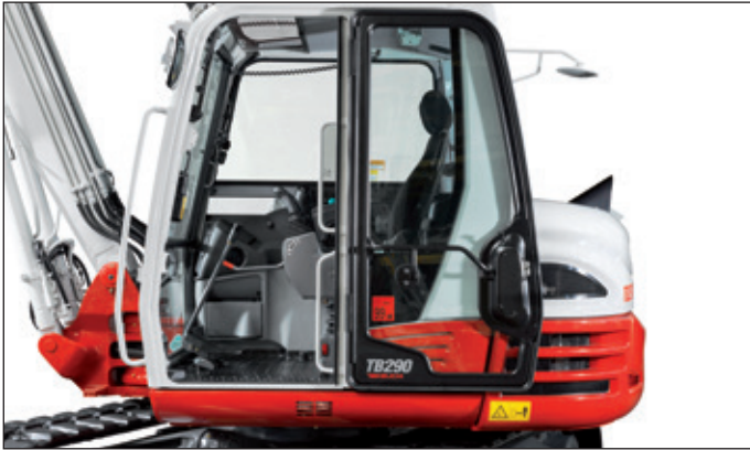
Amplia cabina insonorizada, pobre en vibraciones, compartimentos para guardar cosas, entrada ancha con fijación masiva de puerta, cristal frontal abatible, aire acondicionado.
