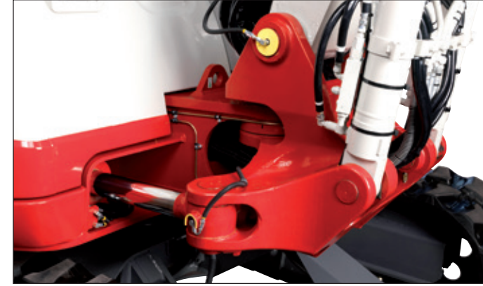
Bloque de giro robusto con cilindro de giro. Cilindro de elevación con amortiguación en el final de carrera. Aviso de sobrecarga y válvula antiretorno de serie.
