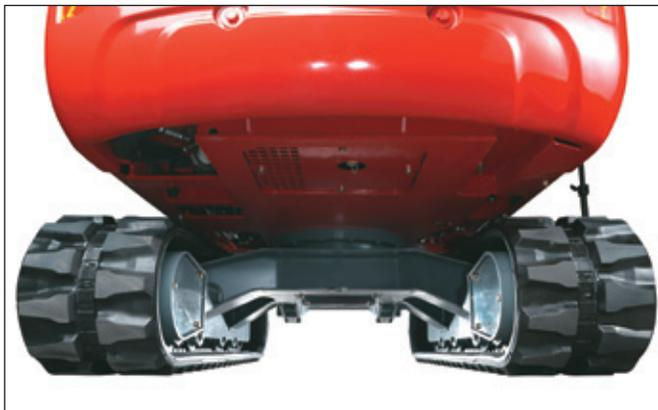
Gran distancia del eje hasta el suelo, cárter del motor cerrado y protegido
