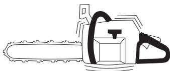
Compruebe que los elementos antivibraciones estén bien anclados entre la parte del motor y la parte de los mangos, respectivamente.
