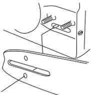
Tense la cadena enroscando en el sentido de las agujas del reloj el tornillo de tensado con la llave combinada. La cadena debe tensarse hasta que deje de colgar en la parte inferior de la espada. Vea las instrucciones del capítulo Tensado de la cadena de sierra.
