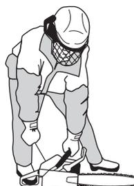
Cuando el motor encienda, oprima inmediatamente el estrangulador y repita los intentos de arranque hasta que el motor se ponga en marcha. Cuando arranque el motor, acelere al máximo y se desacoplará automáticamente la aceleración de arranque.
