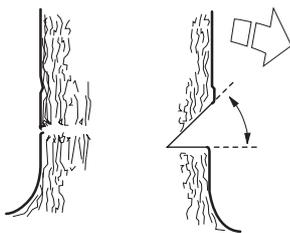
La convergencia de ambos cortes se denomina línea de corte de indicación. La línea de corte de indicación debe ser perfectamente horizontal y formar un ángulo recto (90°) con la dirección de derribo elegida.
