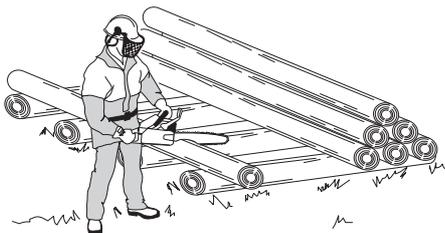
**El tronco en el suelo.** No hay riesgo de atasco de la cadena o de partición del objeto de corte. Sin embargo, hay un riesgo considerable de que la cadena toque el suelo después del corte.
