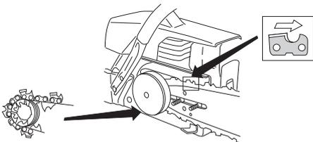
Compruebe que los filos de los eslabones de corte estén orientados hacia delante en la parte superior de la espada.
