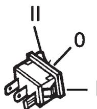
El interruptor está desactivado en la posición "0", entrega corriente para calefacción de los mangos en la posición "I", y entrega corriente para calefacción del carburador en la posición "II".
