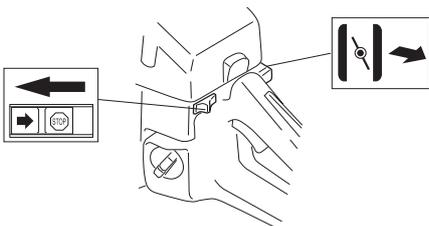
Si la máquina tiene una válvula de descompresión (A): oprima la válvula para reducir la presión en el cilindro y facilitar el arranque de la máquina. La válvula de descompresión debe utilizarse siempre para los arranques. Una vez que ha arrancado la máquina, la válvula vuelve automáticamente a la posición de partida.
