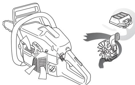
**¡IMPORTANTE!** Para que la depuración centrífuga funcione satisfactoriamente, debe efectuarse un mantenimiento constante del sistema. Limpie la toma de aire del mecanismo de arranque, las palas de ventilador del volante, el espacio alrededor del volante, el tubo de admisión y el compartimiento del carburador.
