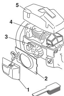
Limpe el sistema refrigerante con un cepillo una vez por semana (en condiciones difíciles, con mayor frecuencia). Un sistema refrigerante sucio u obturado produce sobrecalentamiento de la máquina, con las consiguientes averías del cilindro y el pistón.
