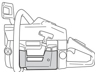
¡NOTA! Si se ha montado el conjunto especial de invierno o si se han tomado medidas para aumentar la temperatura, debe cambiarse al reglaje normal, puesto que la máquina funciona con temperatura normal. De lo contrario, hay riesgo de sobrecalentamiento con las consiguientes averías graves del motor.
