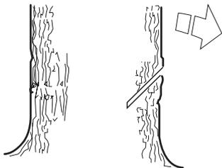
Luego, efectúe el corte inferior, que debe terminar exactamente donde terminó el corte superior.
