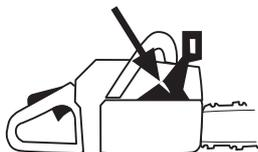
Empuje la protección contra reculadas adelante y atrás para comprobar que se mueve con facilidad y que está firmemente anclada a su articulación en la cubierta del embrague.
