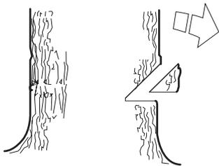
La profundidad del corte de indicación debe ser igual a 1/4 del diámetro del tronco, y el ángulo entre los cortes superior e inferior debe ser de 45° como mínimo.
