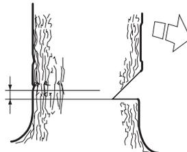
Coloque el apoyo de corteza (si ha sido montado) detrás de la faja de desgaje. Corte con aceleración máxima introduciendo lentamente la cadena/espada en el tronco. Preste atención a si el árbol se mueve en dirección opuesta a la elegida para el derribo. Tan pronto lo permita la profundidad de corte, ponga una cuña de derribo o una barra desgajadora en el corte de derribo.
