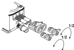
Si el carburador de su motosierra tiene limitadores de movimiento, hay que ajustarlo siguiendo las instrucciones bajo el titular 'Carburador con limitadores de movimiento'.
