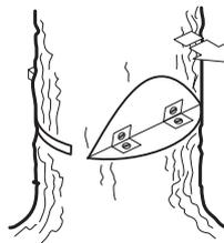
Se pierde completamente el control de la dirección de derribo del árbol si la faja de desgaje es demasiado pequeña o se atraviesa al cortar, o si los cortes de indicación y derribo están mal situados.
