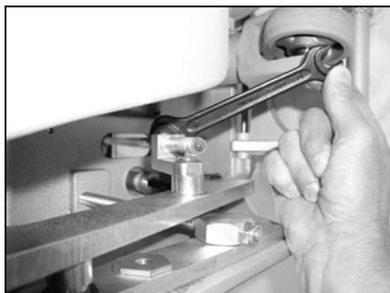
Puede ajustarse la altura del eje del mango:
