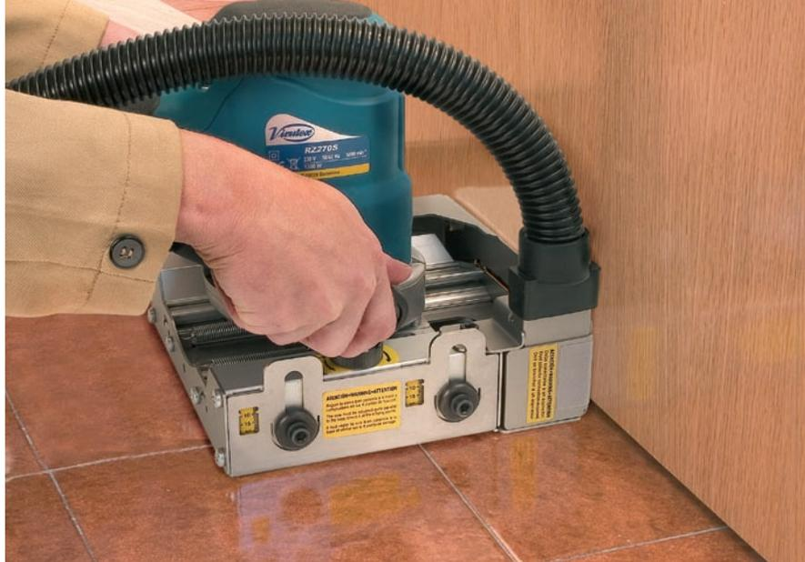
La posibilidad de extraer el frontal de la máquina muy fácilmente, permite mejorar el acceso a las esquinas, en el recorte de zócalos.
