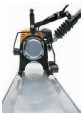
Perfil curvo, especialmente diseñado para empuje y arrastre del hormigón. La planitud y el acabado conseguido en la solera hacen innecesaria la función del talochado posterior.
