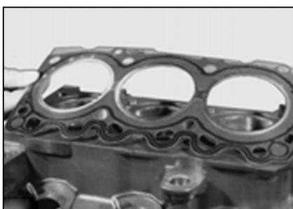
Fig. 17: Colocación de la junta de culata
