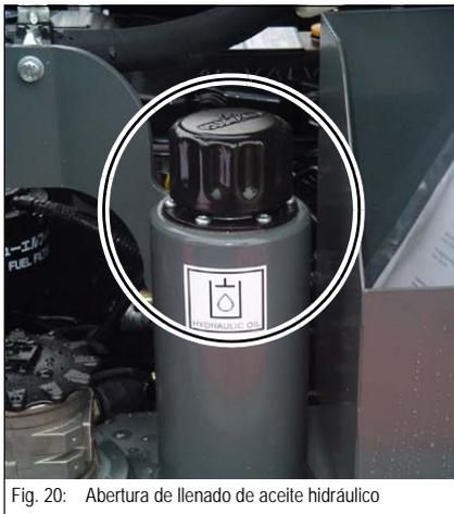
Fig. 20: Abertura de llenado de aceite hidráulico
