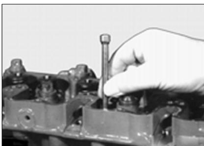
Fig. 20: Colocación de los taqués
