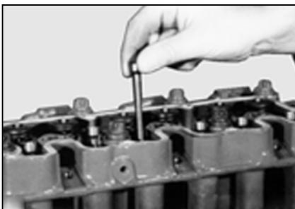
Fig. 14: Desmontaje de los taqués
