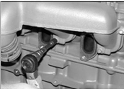
Fig. 23: Juntas tubo de aspiración de aire
