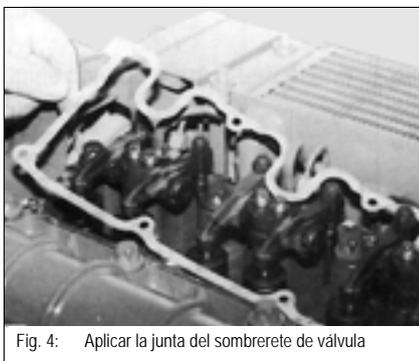
Fig. 4: Aplicar la junta del sombrerete de válvula
