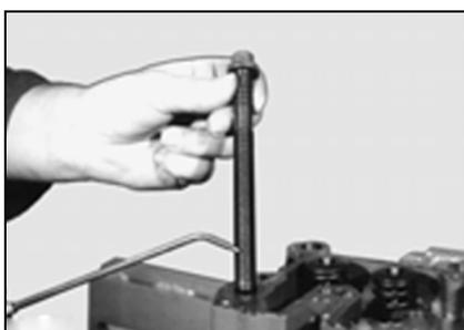
Fig. 18: Colocación de la junta de culata
