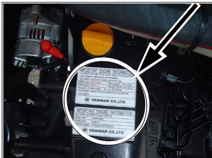
Fig. 3: Número del motor diesel
