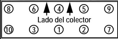
Fig. 19: Montaje de los tornillos de la culata
