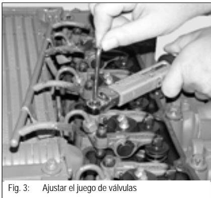
Fig. 3: Ajustar el juego de válvulas
